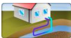
Pompa ciepła: gruntowa, wymiennik na wodę gruntową
